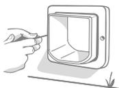
Placez la chatière sur la porte et glissez le cadre extérieur sur le tunnel. En maintenant le produit fermement en place, fixez le cadre extérieur à l'aide du tournevis cruciforme et des vis choisies. Fixez la première vis mais sans trop serrer puis procédez de la même façon pour la deuxième. Une fois les vis en place, serrez-les.
