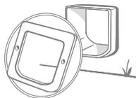
À l'extérieur de la maison, vérifiez que le tunnel est au centre de l'ouverture et ne repose pas sur un des bords, puis placez le deuxième adaptateur de montage sur le tunnel avec le côté enduit de joint face à la porte. La personne à l'intérieur de la maison doit appuyer sur la charnière pour s'assurer qu'elle reste en place.
