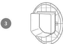
3 Placez un des adaptateurs de montage (peu importe lequel) sur le tunnel de la charnière avec le côté enduit de joint tourné vers l'extérieur et sans qu'il touche aucune surface.
