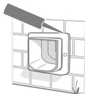
Enfin, utilisez un joint résistant aux intempéries pour sceller l'espace entre le tunnel et le cadre extérieur. Nous vous recommandons également de mettre du joint autour de la jointure entre le cadre extérieur et le mur.
